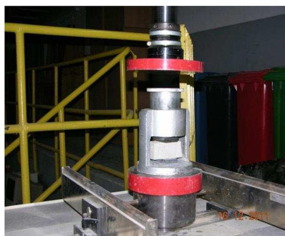
Rys. 5.2. Stanowisko badawcze zaprawy: a) nośność na rozciąganie (poprzez zginanie), b) nośność na ściskanie
