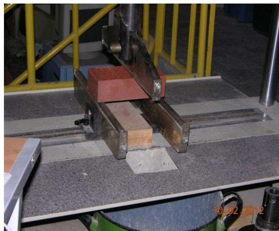
Rys. 5.1. Stanowisko badawcze cegły: b) nośność na ściskanie, a) nośność na rozciąganie (poprzez zginanie)
