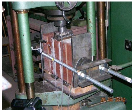
Rys. 5.4. Stanowisko badawcze wytrzymałości połączenia zaprawy z ceglami: a) na oderwanie, b) na ścięcie
